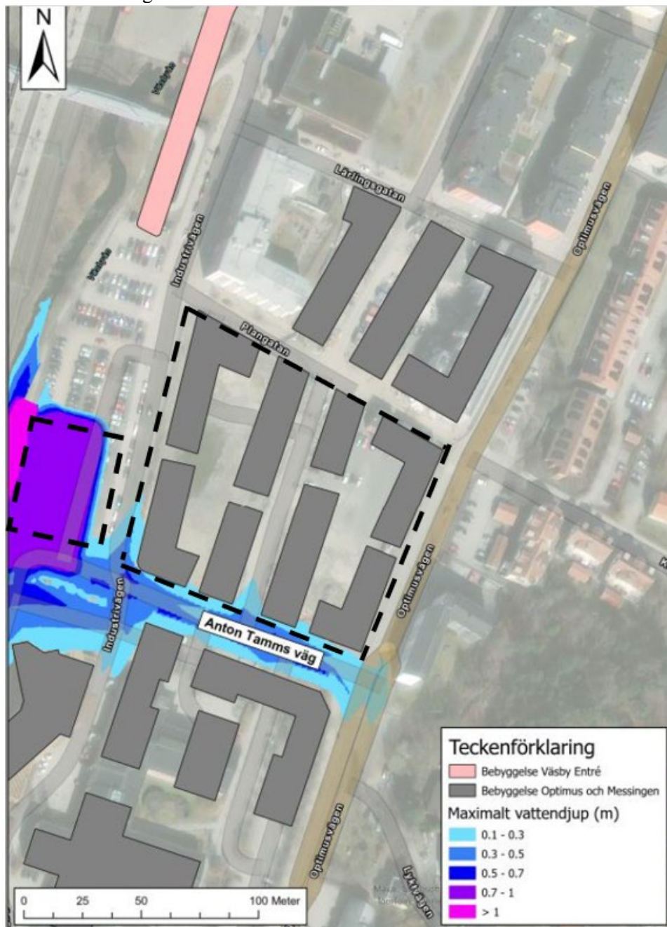
Figur 6. Maximalt vattendjup vid ett 200-årsflöde för framtida scenario där bebyggelse för Messingen och Väsby Entré inkluderats. Ungefärligt planområde markerat med svartprickat, avvikelser kan förekomma. Bild från PM – Utlåtande Messingen översvämningsrisker, Tyréns, daterad 2024-05-17.
