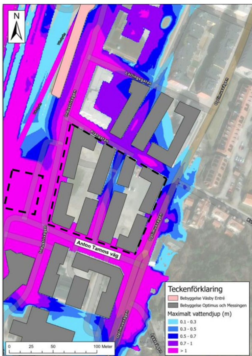
Figur 7. Maximalt vattendjup vid ett Beräknat högsta flöde (BHF) för framtida scenario där bebyggelse för både Messingen och Väsby Entré inkluderats. Ungefärligt planområde markerat med svartprickat, avvikelser kan förekomma. Bild från PM – Utlåtande Messingen översvämningsrisker, Tyréns, daterad 2024-05-17.
