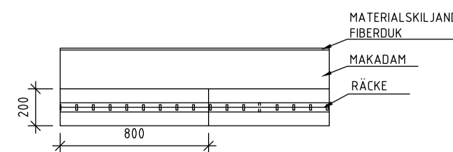
STÖDMUR I BLOCKSTEN AV GRANIT PLAN SKALA 1:20
